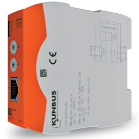
Das POWERLINK Gateway Modul kann unter anderem den Revolution Pi in POWERLINK-Netzwerke einbinden.
