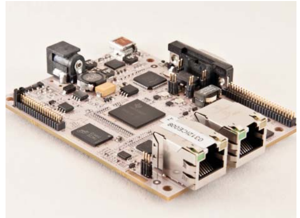
Die Industrielle Kommunikation Engine (ICE) AM3359 ist ein kosten- und größenoptimiertes Entwicklungsboard im Taschenformat für I/O-Geräte und Sensoren. Foto: TI
