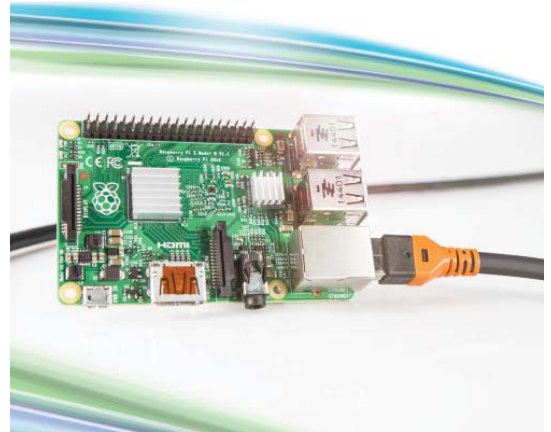
Kalcito hat POWERLINK auf einem Raspberry Pi2 mit Linux implementiert.
