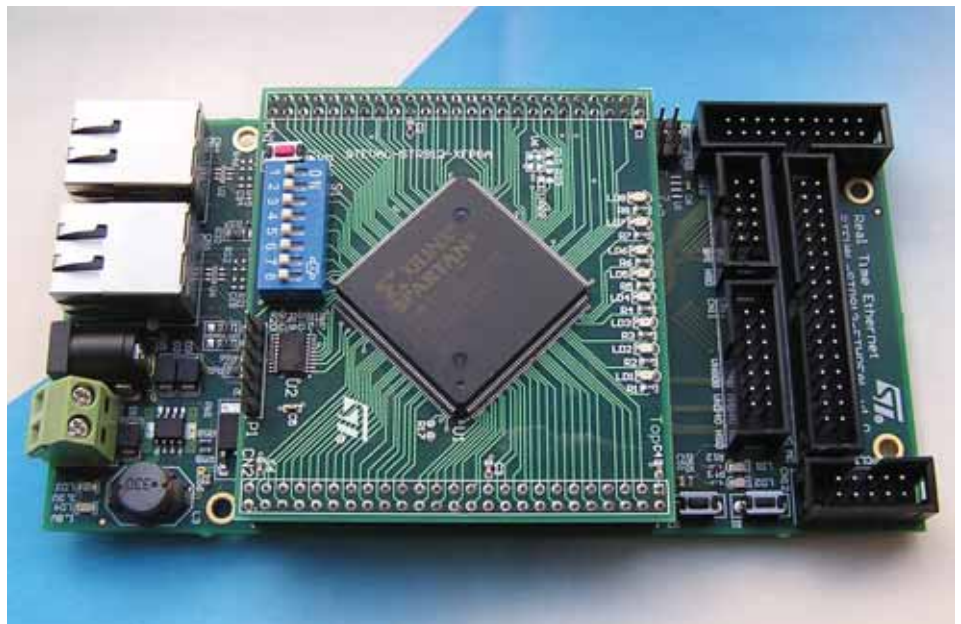
Bild: Trägerboard STEVAL-IFW001V1 mit aufgesteckter FPGA-Erweiterung
