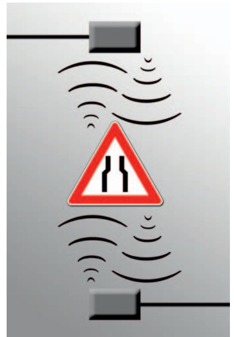
Bild 1: Bei der WLAN-Übertragung entstehen zusätzliche Latenzzeiten. Die Entscheidung, ob WLAN eingesetzt werden kann, hängt immer von dem geforderten zeitlichen Determinismus ab.
